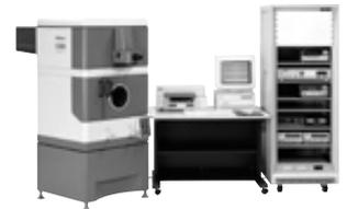
Interferometer als Normal für die Endmaßkalibrierung
