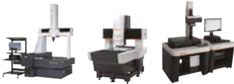
**Machines de mesure tridimensionnelle et par analyse d'image, appareil de mesure de profil et des états de surface, capteurs CPS et WLI**
