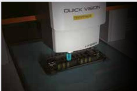
Esempio di misura di una centralina motore
