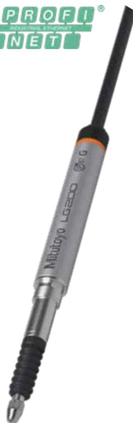
I Linear Gauges Mitutoyo sono disponibili con un'ampia gamma di campi di misura e risoluzione e utilizzano encoder lineari a trasmissione ottica con connettività di interfaccia industriale. Grazie alla struttura robusta, ai cuscinetti lineari a sfere di lunga durata e al design ad alta densità, queste soluzioni sono ideali per le misure in linea anche in ambienti difficili o pericolosi.
