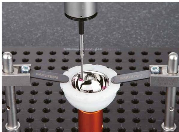
Hochpräzise 3D-Freiformflächen, wie sie bei orthopädischen Implantaten vorkommen, lassen sich schnell und unkompliziert mithilfe von scannenden Messkopfsystemen messen und aufgrund der äußerst geringen Antastkraft wird dabei sichergestellt, dass auf den sensiblen medizinischen Oberflächen keine Spuren vom Taster hinterlassen werden. Zudem kann basierend auf den erhaltenen Messpunkten eine dreidimensionale Fehleranalyse durchgeführt werden.
