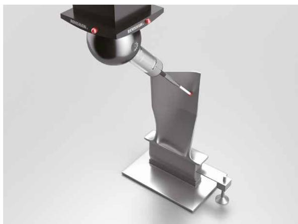
Die Analyse und Auswertung der einzelnen Querschnitte entlang einer Turbinenschaufel sind wichtige Werkzeuge bei der Produktdatensicherung, aber ihre in sich gewundene Form ist in der Regel äußerst fehleranfällig. Ein scannendes Messkopfsystem in Verbindung mit einem Dreh-/Schwenksystem eignet sich bestens, um ein solch hochkomplex geformtes Werkstück schnell und zuverlässig zu messen.
