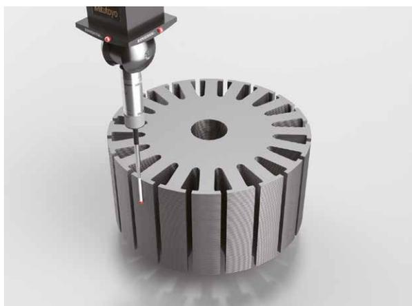
Für die vielfältigen verschiedenen Messaufgaben an laminierten Motorkernen eignen sich scannende Messkopfsysteme. Die verschiedenen Form- und Lagetoleranzen, wie die Geradheit der laminierten Höhen oder die Position der laminierten Lagen zueinander, lassen sich so problemlos erfassen.
