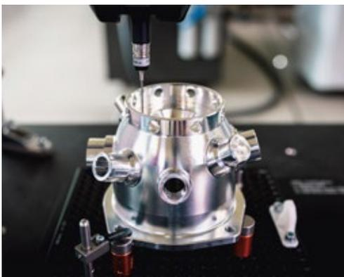
auf einem KMG aufgespanntes Werkstück
