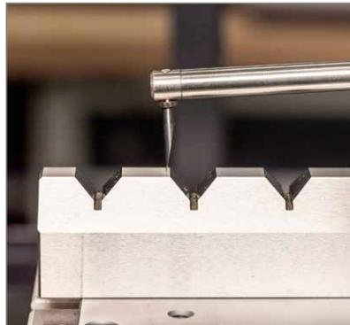
Längenmessabweichung der X-Achse eines Konturmessgeräts
