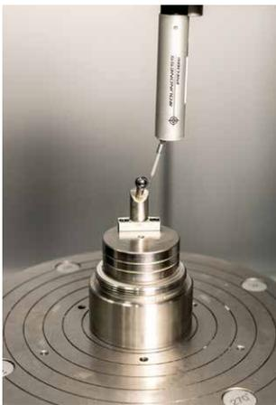
Überprüfung des Tastsystems
