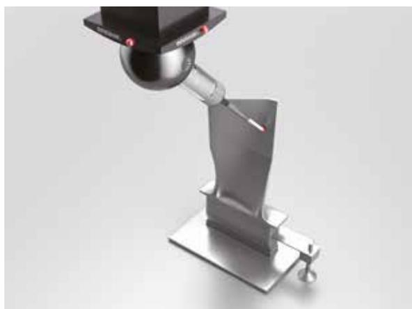
La sezione trasversale di una pala di una turbina di un motore d'aviazione può essere misurata utilizzando una sonda di scansione compatta e ad alta accuratezza, in grado di misurare, in modo rapido e affidabile, pezzi solitamente soggetti a notevoli errori, come i getti.
