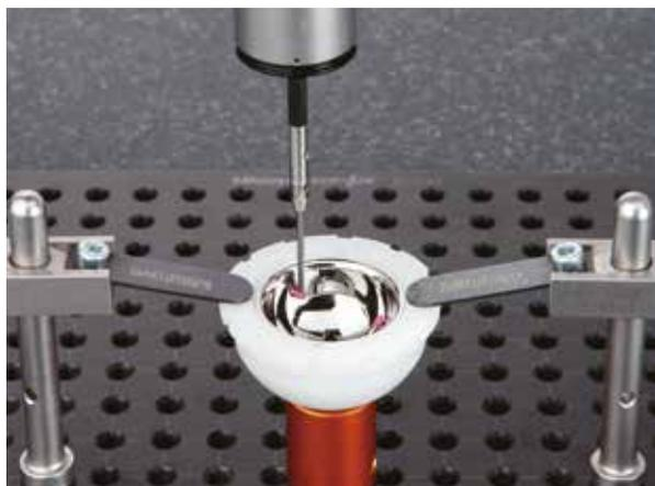
La misura della superficie a forma libera delle articolazioni protesiche può essere condotta utilizzando una sonda di scansione compatta ad alta accuratezza, con la possibilità di eseguire un'analisi di errore tridimensionale basata sui punti di misura ottenuti.
