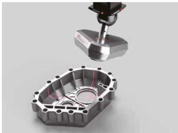
Le sonde laser senza contatto richiedono tempi di misura notevolmente inferiori rispetto alle sonde a contatto (scansione). La scansione contemporanea da tre direzioni consente la misura simultanea delle facce superiori e laterali, il che significa che è necessario un minor riposizionamento per una misura efficiente anche dei pezzi più complessi.
