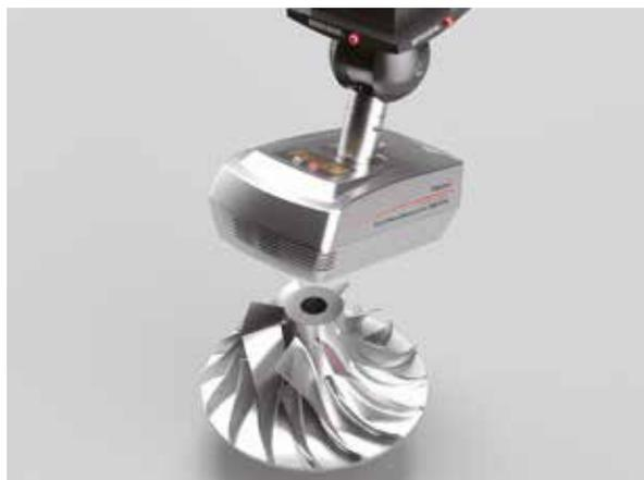
Le giranti possono essere misurate utilizzando una sonda laser senza contatto altamente resistente che riduce le riflessioni multiple. Accurato come le sonde a contatto, questo scanner laser offre un'elevata riproducibilità geometrica.
