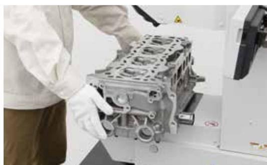
Pezzi di grandi dimensioni come monoblocchi motore possono essere montati sulla tavola. È possibile testare pezzi con peso fino a 100 kg.
