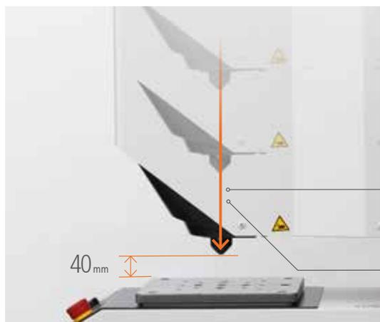
Primi durometri Mitutoyo ad essere dotati di teste mobili (la testa si muove a una velocità di 10 mm/s entro un campo di 210 mm).
