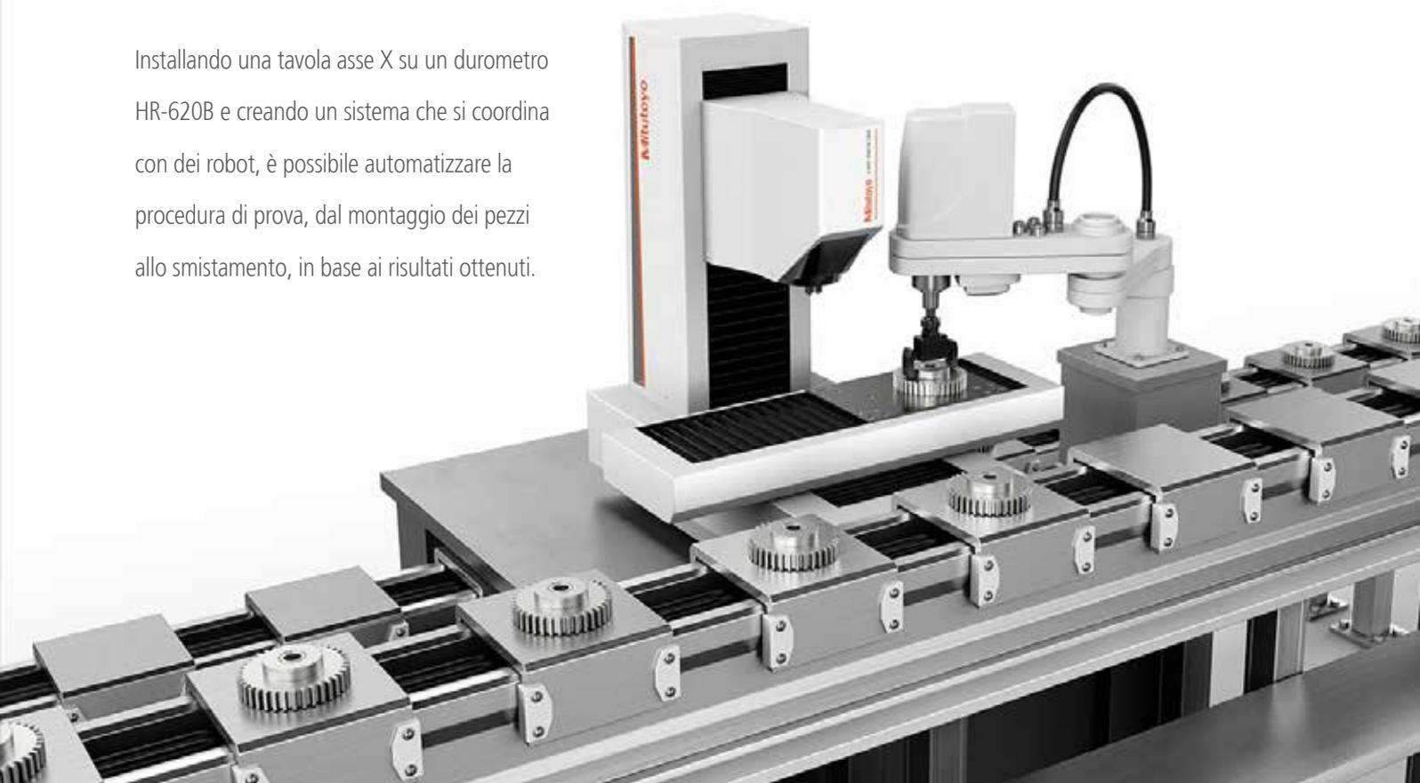
Esempio di automazione del durometro Rockwell su una linea di produzione
