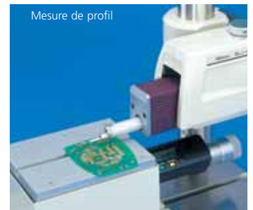
Mesure avec statif et table de mise à niveau
